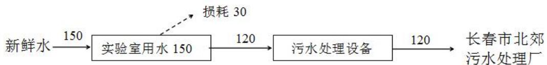
图 2 项目水平衡图 (m<sup>3</sup>/a)
